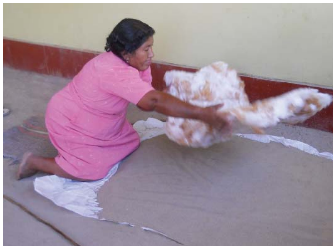
Foto 2 Acomodando la mezcla para formar el rollo
